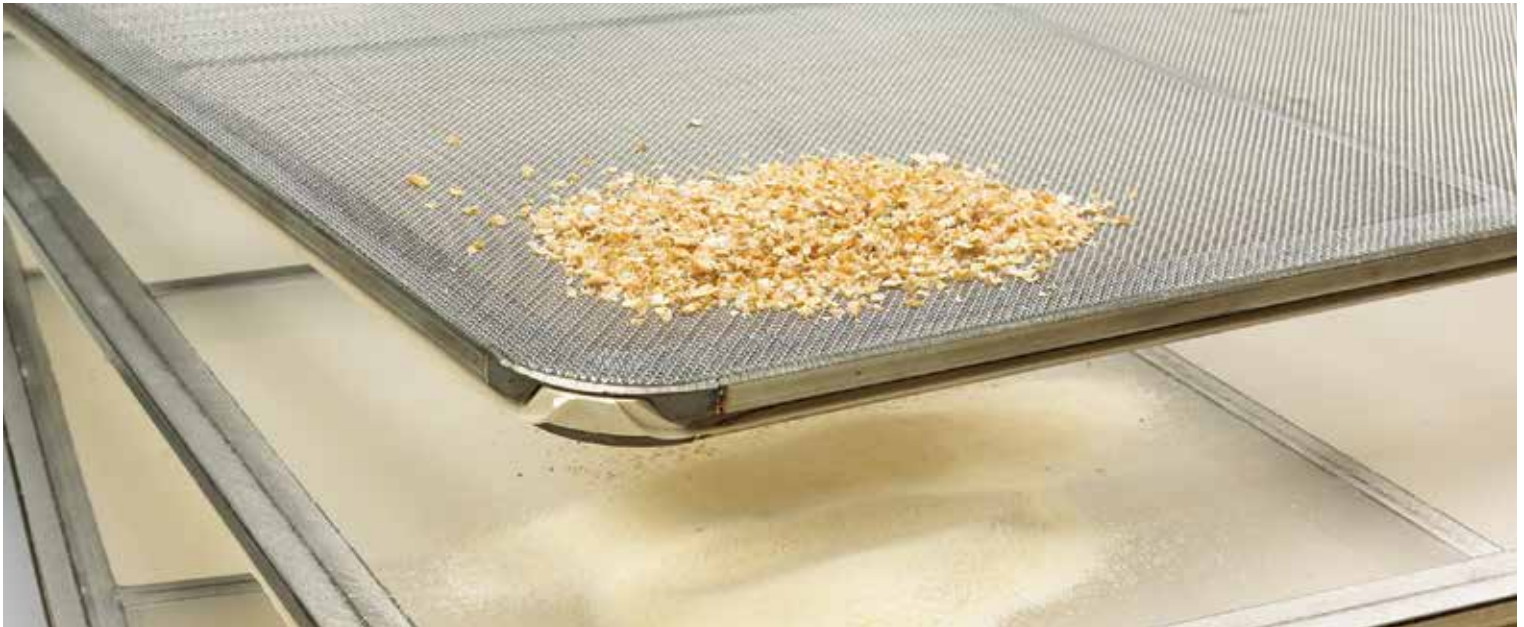
Der Plansichter sortiert das Mahlgut.
