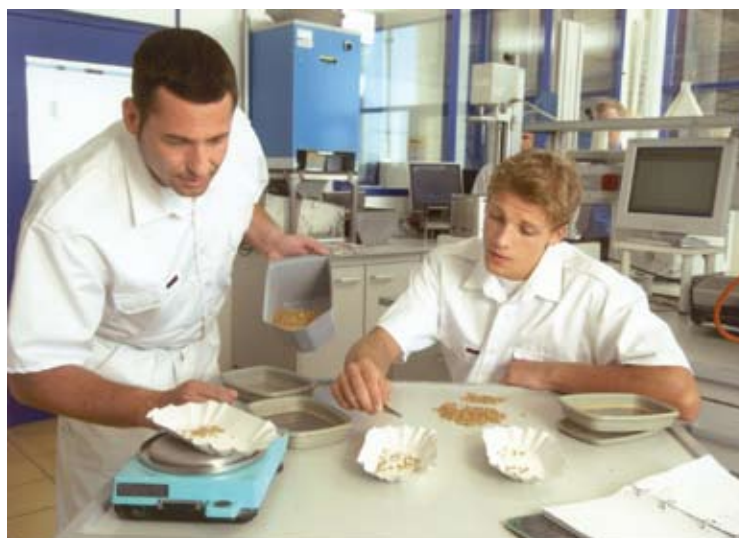
Besatzanalyse in der Mühle zur Beurteilung einer Getreideprobe
