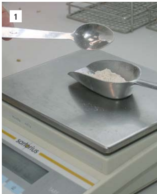
Genauigkeit durch sorgfältige Analytik: Abwiegen der Mehlsprobe (1), Doppel-Analysegerät für parallele Gegenprobe (2), Ergebnis direkt auf den Drucker (3)
