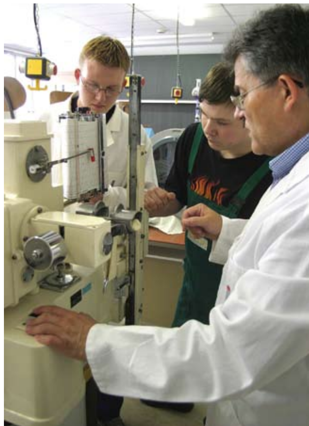
Mit dem Extensographen die Teigelastizität ermitteln
