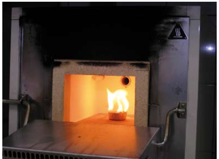
Hier verglüht eine Mehllprobe zur Bestimmung des Mineralstoffgehalts in einem „Muffelofen“
